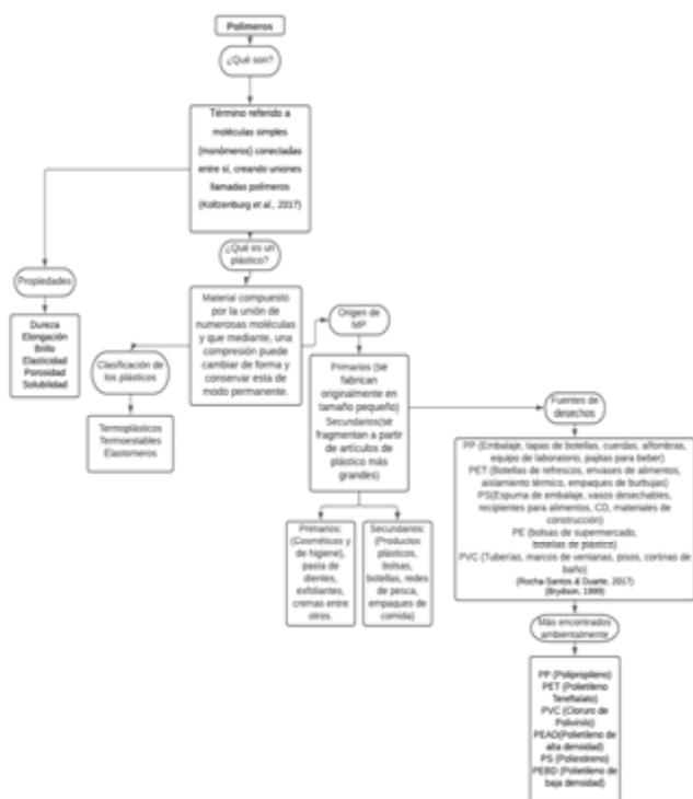
Figura 1. Diagrama de polímeros y su origen, fuentes, propiedades y clasificación. Nota: MP = microplástico.
